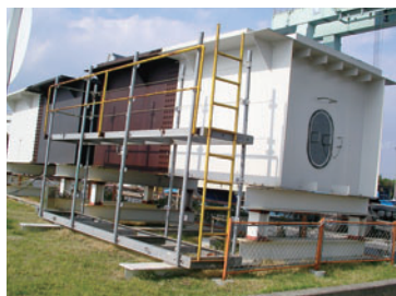
鋼橋箱桁実験プラント
