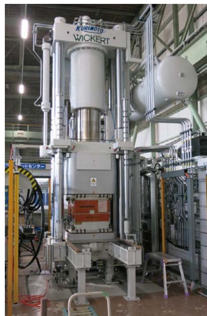
470ton 樹脂成形用油圧プレス機
