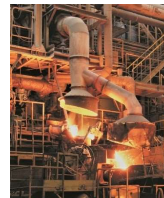
キュポラ溶解設備
