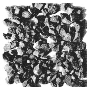
A社インパクトプロダクト ふるい分け後 (10~5 mm) V=50m/s
