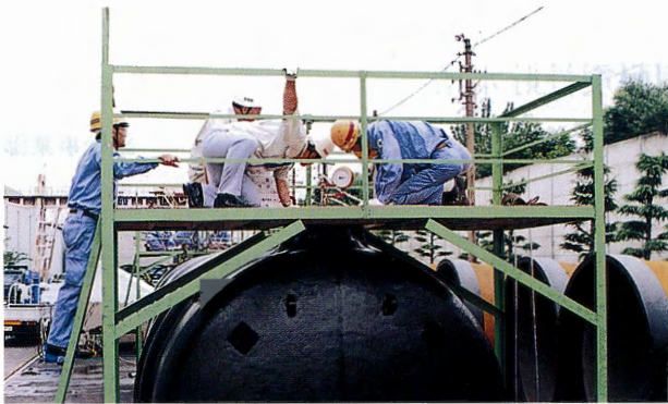
図5 水密性試験（水圧1.23MPaを5分間負荷し、異常のないことを確認した。）
