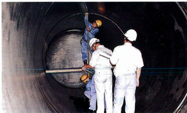
図7 内径寸法測定（貯水容量の確認）
