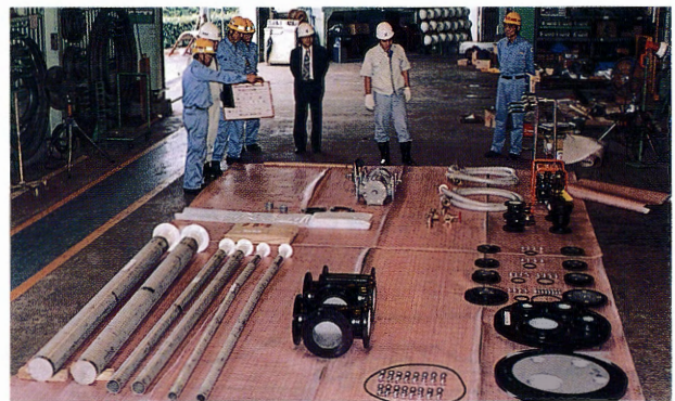
図10 付帯設備確認（流入・流出管、ウイングポンプ、給水管、導水管など）
