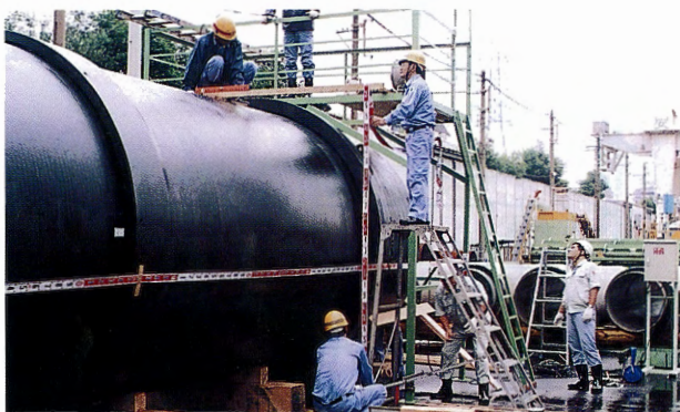
図6 全長測定（貯水容量の確認）
