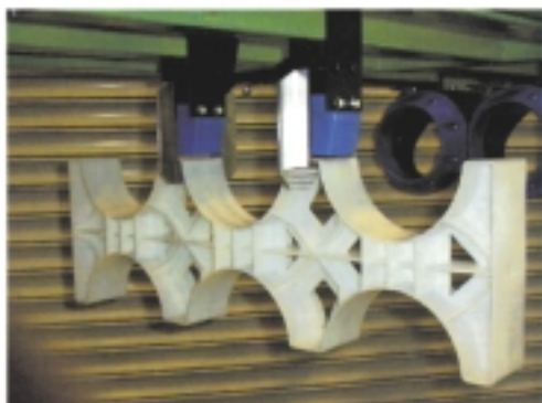
図8 管枕固定クランプ(管枕をクランプ) Fig. 8 Pipe-cleat fixing clamp (Pipe cleat clamped)
