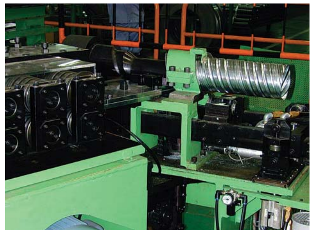
図10 製管ステーション Fig. 10 Pipe forming machine
