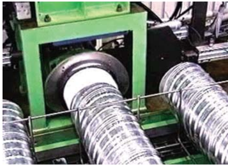
図17 パイプ端部用キャップ挿入ステーション Fig. 17 Station of caps insertion
