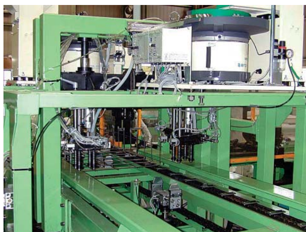
図13 樹脂製キャップ挿入ステーション Fig. 13 Station of resinous caps insertion
