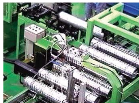
図16 溶接ステーション Fig. 16 Welding station
