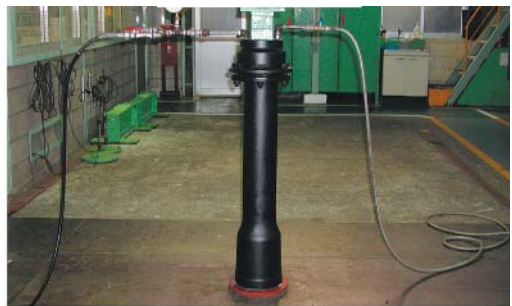
管体水圧試験
