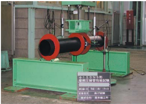
管体曲げ試験
