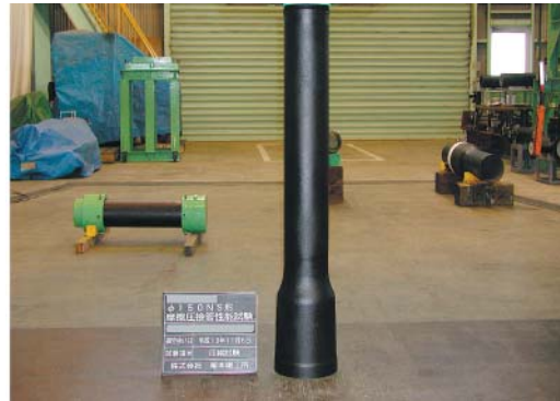
管体圧縮試験
