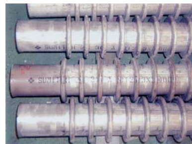
図4 成形完成後のパイプの写真 Fig. 4 Appearance of pipe after hydroforming
