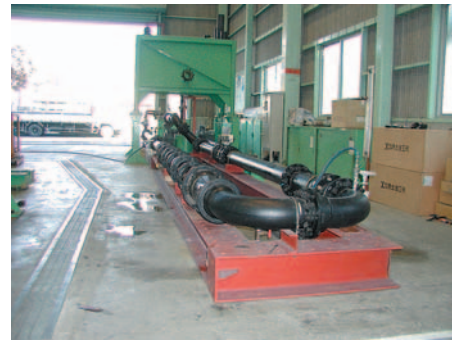
図8 ポリピグ通過試験管路 Fig. 8 Polly-Pig passage test equipment
