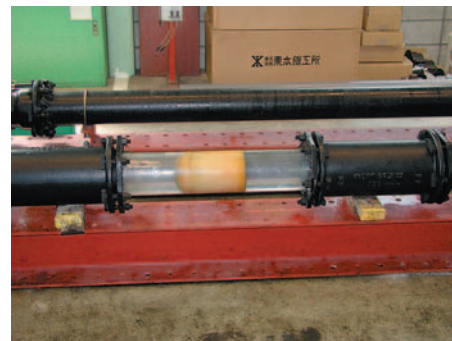
図9 ポリピグ通過試験状況 Fig. 9 State of Polly-Pig passage test
