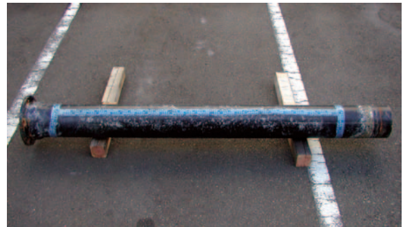
図10 Zn-Al擬合金溶射+合成樹脂塗装φ200(6年目) ショットブラスト前
