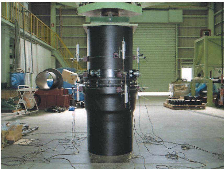
図4 滑り抵抗試験測定試験状況
