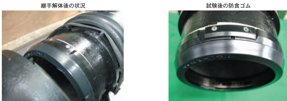
図12 接合試験結果 Fig. 12 Joint test result
