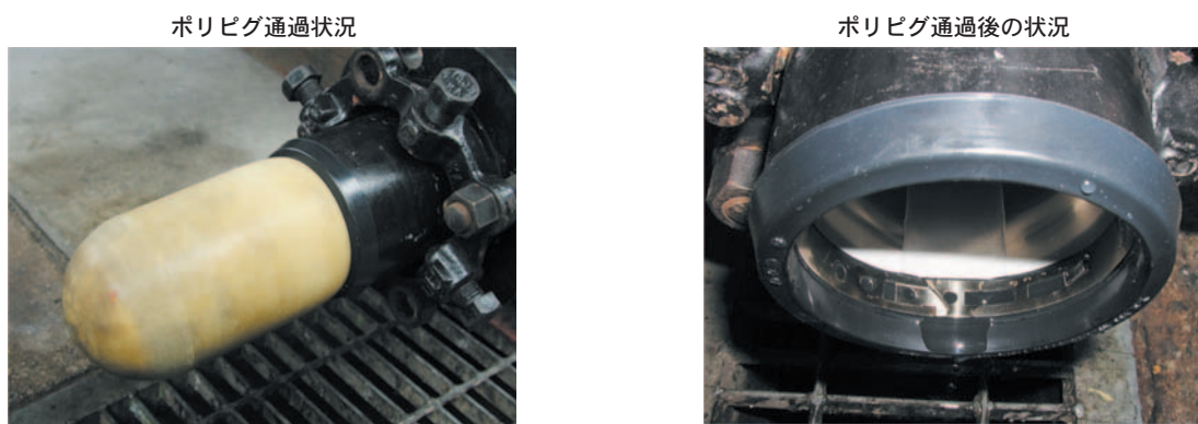
図13 ポリピグ通過試験結果 Fig. 13 Polly-Pig passage test result
