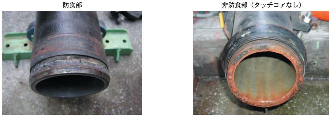
図11 防食試験結果 Fig. 11 Corrosive protection test result
