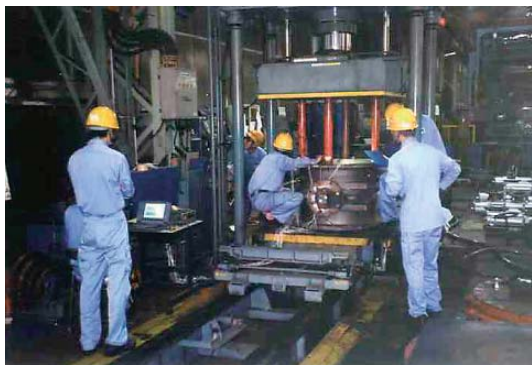
図5 水圧試験状況
