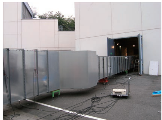
図7 圧力損失試験状況
