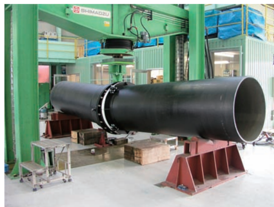
図19 φ900継手曲げ実験状況
