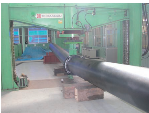
図18 φ500継手曲げ実験状況
