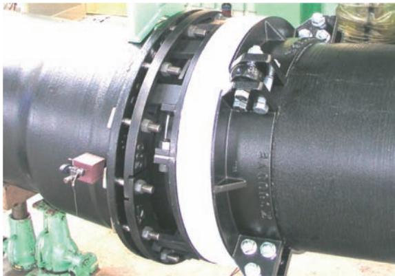
図23 φ500継手7°曲げ状況
