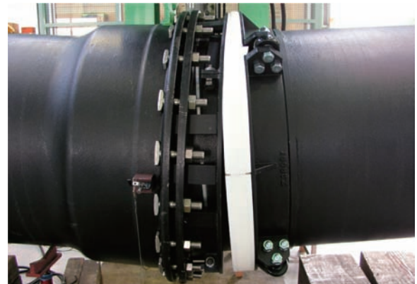
図24 φ900継手7°曲げ状況
