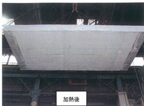
図6 試験前後の試験体加熱面の状況
