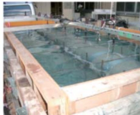
図3 呼び径450mmの水没試験概要
