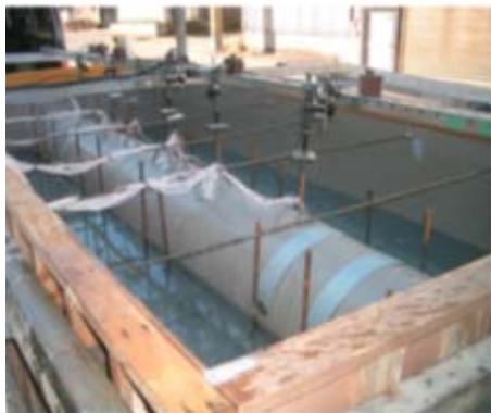
図3 呼び径450mmの水没試験概要
