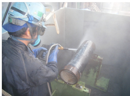
図17 銃身長8mmによるブラスト状況（管横）
