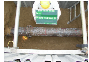
図5 黒鉛化部除去後の調査管
