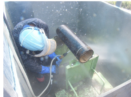
図18 銃身長8mmによるブラスト状況（管下）
