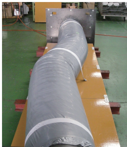
図7 サイレントフレックスP・PAタイプ耐圧試験結果
