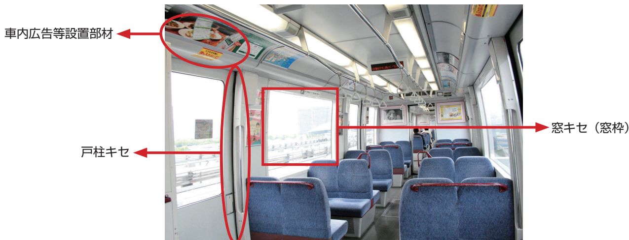
図 3 鉄道車輛 FRP 部品の使用例
