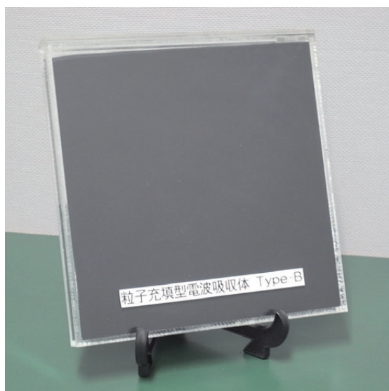
図3 粒子充填型電波吸収体のサンプル (アクリル製のセルに充填)
