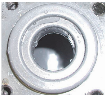
図8 100日経過後の分岐孔の状態
