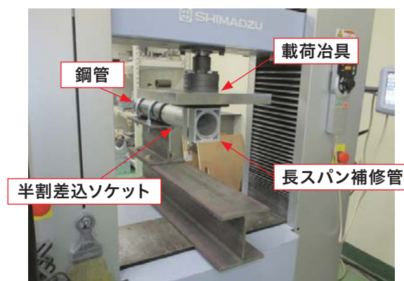
図8 半割差込ソケット曲げ試験
