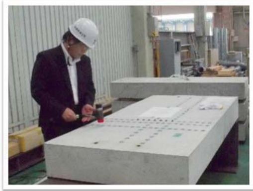
図15 遮音試験状況
