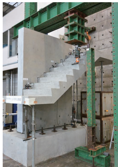
図7 実大試験体の加力状況
