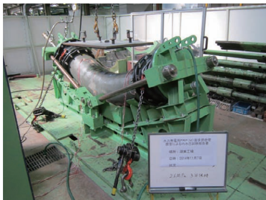
図5 内水圧試験状況
