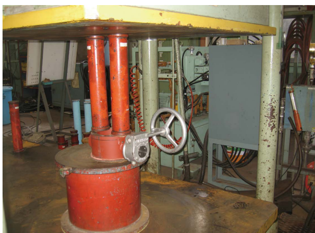
図8 供試弁および漏洩試験状況
