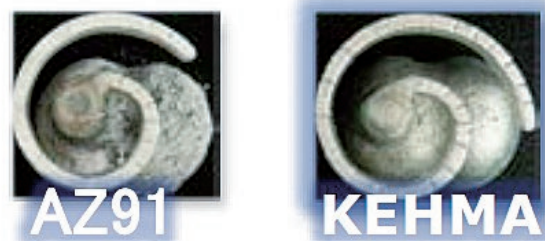
図10 湯流れ試験結果
