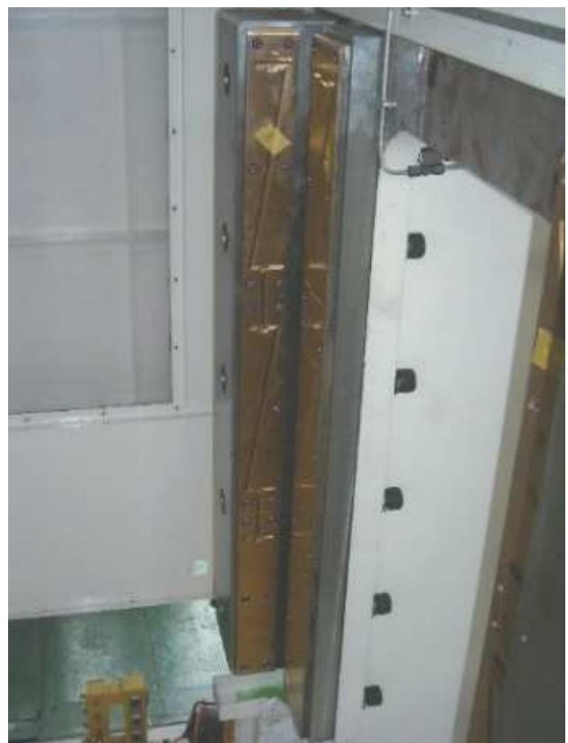
図16 当社製鍛造プレスC2Pに取付けたプロベアライナ
