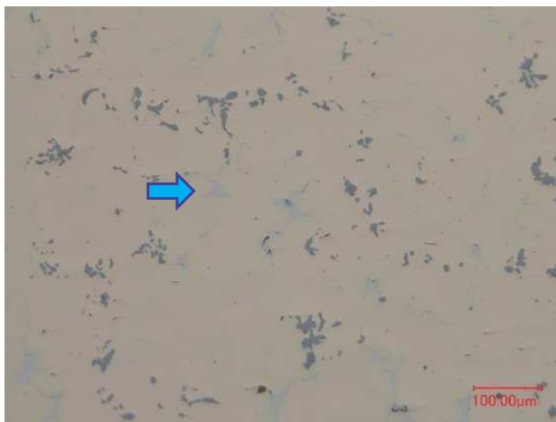
図1 プロベア鋳造材の金属組織
