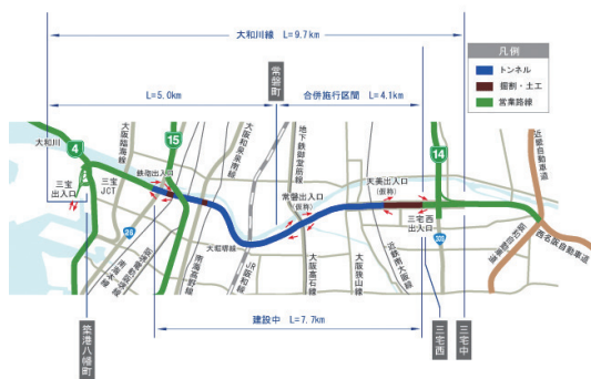
図20 阪神高速大和川線工事区間 3)
