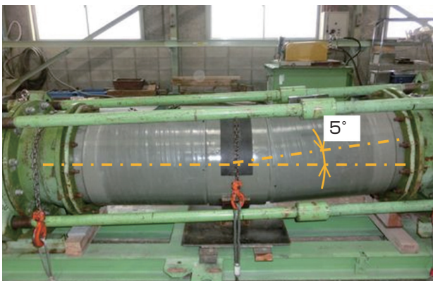
図10 内水圧試験状況（片側5°曲げ）
