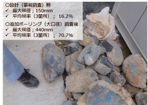
図12 シールド工法区間において出現した巨礫
