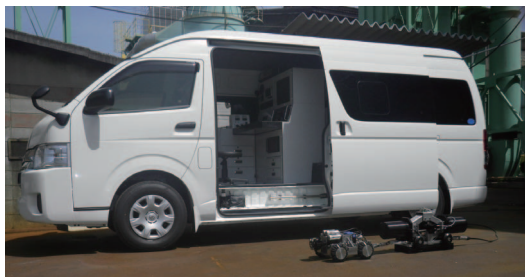
図2 管内カメラ 機材搭載車
