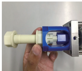
②専用工具の設置 ナットおよびボルト先 端の六角形状部を専用 工具に嵌込む
