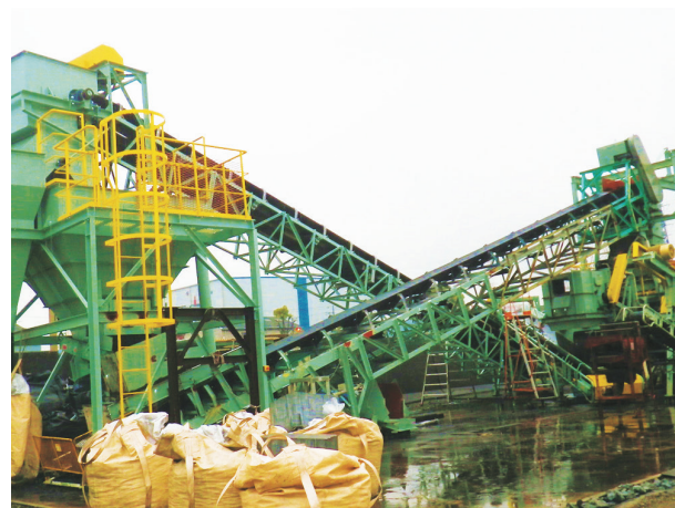
図5 石炭向けローラスクリーン総合試験設備 外観
