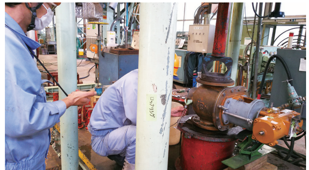
図7 当社工場での漏れ試験
